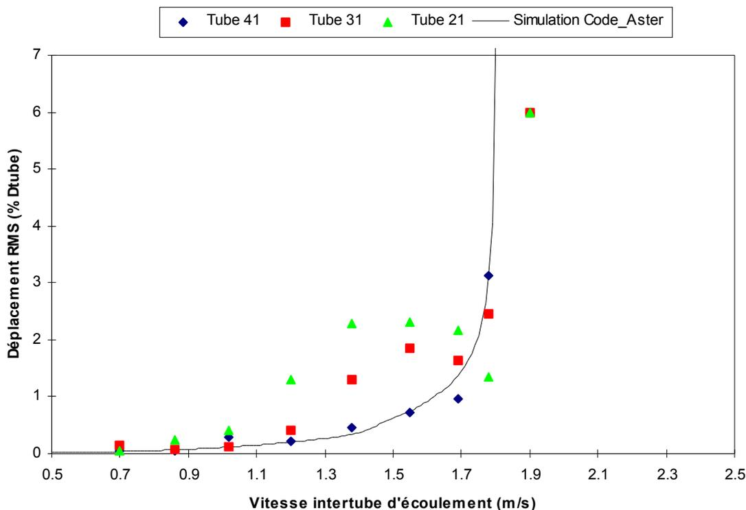
Figure 6.1-a : Déplacement RMS en fonction de la vitesse intertube d'écoulement, exprimé au point E en pourcentage du diamètre extérieur du tube.
