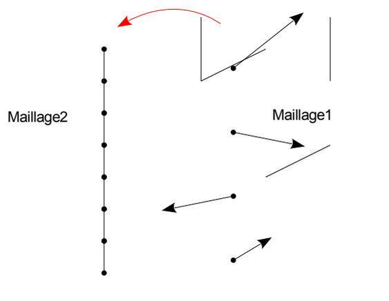
Pour que la technique présentée ici fonctionne, il suffit simplement que les maillages soient parallèles l'un à l'autre (par exemple, il faut qu'ils soient tous les deux suivant l'axe z) et qu'ils aient une plage de coordonnées en commun suivant l'axe suivant lequel ils sont parallèles.
