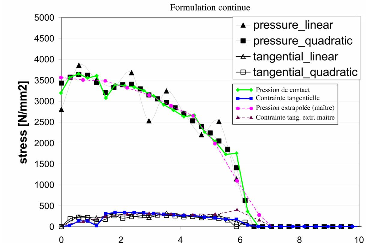
Les résultats obtenus en quadratique avec frottement avec la formulation continue sont en très bon accord avec ceux obtenus dans le benchmark (ici ceux du code MARC).
