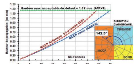
Figure 6 : Évolution de la propagation par fatigue d'un défaut hypothétique dans la MCCP en fonction du temps
