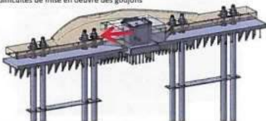
Ancrage de turbine LT75 : glissement de 24 MN difficultés de mise en oeuvre des goujons
