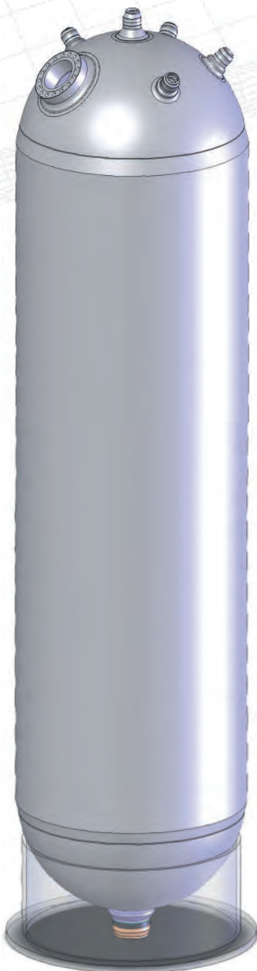
Figure 1 : Pressuriseur (vue 3D).
